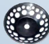
Специально спроектированный универсальный ротор для пробирок объемом 0.2 - 2 мл. Позволяет выполнять как осаждение так и перемешивание.
