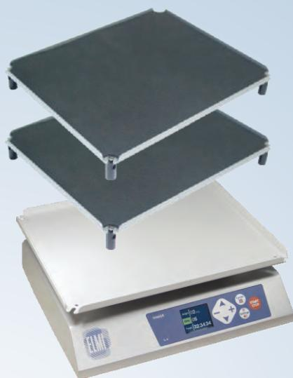
**Качающий цифровой шейкер S-4** предназначен для перемешивания жидкости в лабораторной посуде с помощью качания платформы шейкера в вертикальной плоскости. Благодаря использованию специальной системы привода, шейкер способен изменять не только скорость качания, но и угол в пределах от 1 до 12 градусов. Это позволяет практически в любой ситуации добиться так называемого эффекта стоячей волны, обеспечивающей оптимальное перемешивание.
