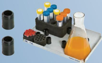
**Магнитные зажимы:** Универсальное средство для фиксации плоскдонных ёмкостей. Обеспечивает максимально надёжную фиксацию даже на максимальных оборотах работы прибора.
