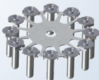
**РОТОР 6М.05 на 12 адаптеров с рабочим углом наклона 10°:**
