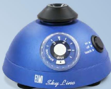
**Вортекс V-3** применяется для перемешивания компонентов жидкости в любых пробирках. Включение вортекса V-3 производится путем нажатия пробиркой в гнездо вортекса нажатием клавиш и постоянного встряхивания.
