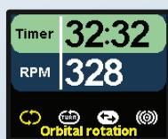
Специально спроектированная система управления обеспечивает наивысший уровень комфорта при работе. используя продуманную навигацию и цветной ЖКИ дисплей настройки производятся легко и быстро.
