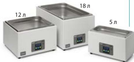
**SBB Aqua Plus boiling bath range** – серия водяных бань для кипячения, состоящая из 3 моделей. Пластиковая крышка и базовая платформа включены в стандартный комплект.
