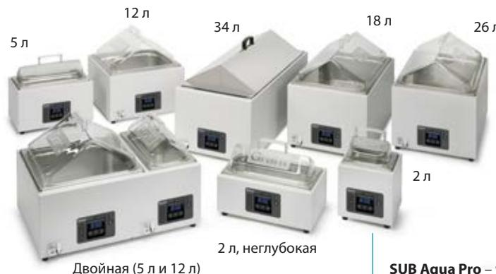
**SUB Aqua Pro** – улучшенная серия водяных бань, состоящая из 8 моделей. Пластиковая крышка, базовая платформа и слив (для бани с большим объемом) включены в стандартный комплект.
